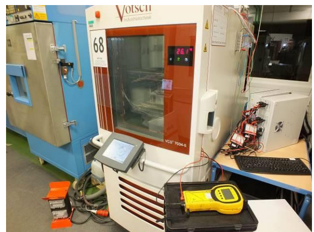
Bild 6 Nanotec ESD in der Klimaprüfkammer 68 während der Konditionierung mit +23°C, 12%rF
