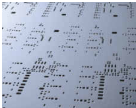
„Basic Plus“ SMD-Schablone für 90 Prozent des Marktes.
