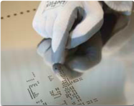
SMD-Schablonen müssen saubere Oberflächen und gratfreie Kanten aufweisen (Bilder: photocad GmbH & Co KG).
