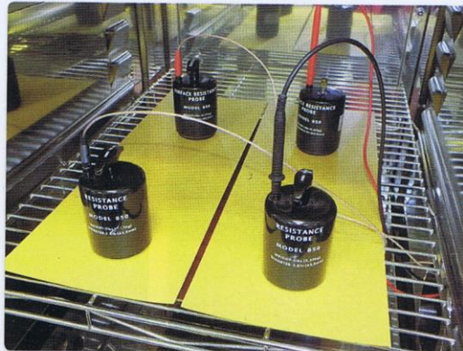
Bei den Messungen wurde der Punkt-zu-Punkt-Widerstand gemäß den Normforderungen sowie gemäß den Festlegungen von Photocad kontrolliert
