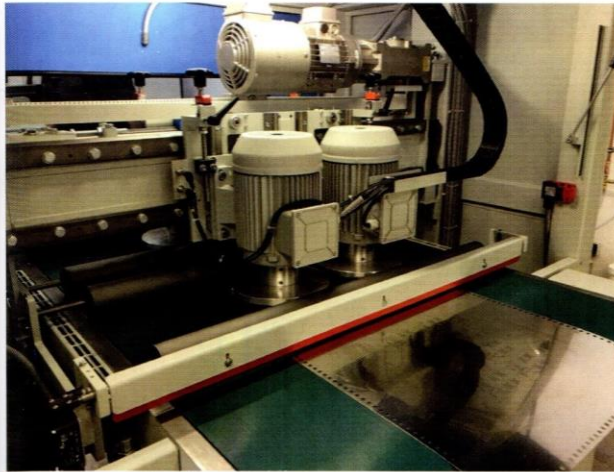
Bild 2: Die Kombination der Soft- sowie der Combidisc macht ein Arbeiten mit sehr feiner Körnung möglich. Die Bearbeitungsvliese der Discs werden kurzfristig und praktisch ohne Aufwand gewechselt, um Verschleiß zuverlässig auszugleichen und die Produktqualität konstant zu halten (Werkbilder: PHOTOCAD GmbH & Co. KG, Berlin)
