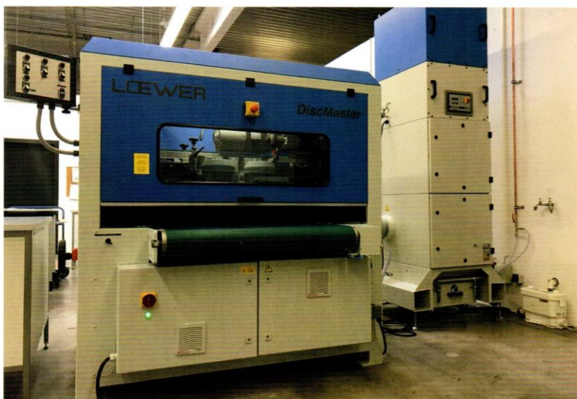
Bild 1: Seit Juli 2017 setzt Photocad zur Entgratung seiner SMD-Schablonen den DiscMaster 4TD von Löwer ein: Durch seine vier oszillierenden Discs können Werkstücke in 360 Grad aus allen Richtungen absolut gleichmäßig bearbeitet werden
