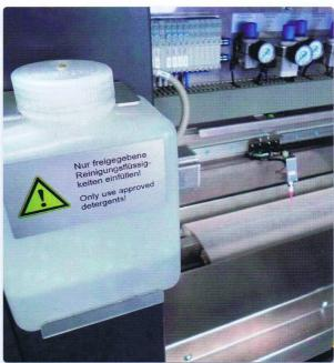
KIWOCLEAN EL 8150 und EL 7700 sind Spezialmittel für die Unterseitenreinigung im Schablonendrucker. Optimale Benetzungseigenschaften verhindern eine Brückenbildung.
