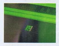
Die Beschriftung besonders dünner und empfindlicher Materialien birgt durch thermische Emissionen oft das Risiko von Verformungen. Die entsprechende Markierung von SMD-Schablonen, wie sie für den Lotpastendruck in der Elektronikproduktion eingesetzt werden, ist zur eindeutigen Identifizierung jedoch unerlässlich. Um ihre Kunden bestmöglich zu
