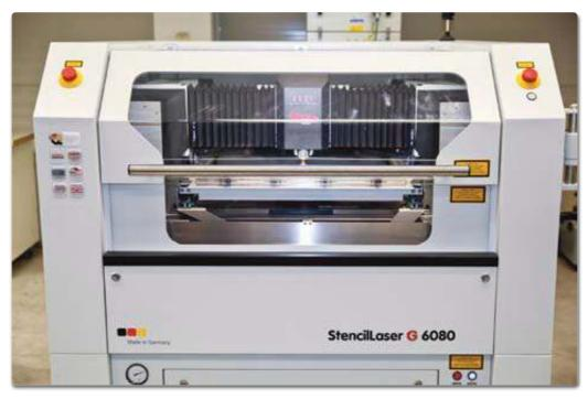
Die neue Laserschneidanlage ist mit einem speziellen Kontrollsystem ausgestattet, das die Schablonen-Öffnungen in Echtzeit scannt und die Parameter gegebenenfalls ändert – ohne Stillstand.
