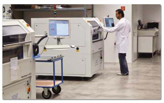
Für seine SMD-Schablonen setzt photocad auf die neuste Laserschneidtechnik und hat 300.000 Euro in ein High-Speed-System von LPKF investiert. Die Anlage wurde eigens entwickelt, um hochpräzise Öffnungen zu erzeugen und dabei den Arbeitsprozess noch zu beschleunigen. Quelle: photocad GmbH & Co. KG
