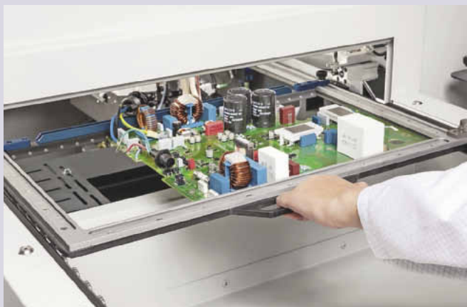
Manuelle Beladung der Smartflow 2020 mit einem Werkstückträger
