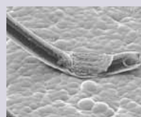
Auf den Metallschichten lassen sich elektronische Bauteile bonden, leitkleben oder löten
