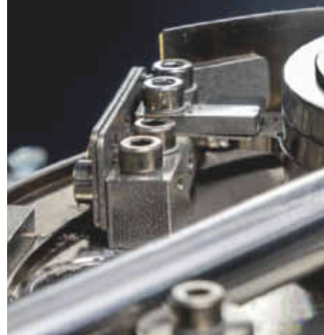
Miniwellen- Lötaggregat mit wartungsfreier Lotpumpe
