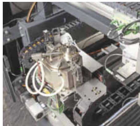
Löttaggregat in gut zugänglicher Wartungsposition
