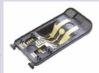
Bei der Metallisierung bauen sich Metallschichten auf den aktivierten Pfaden auf
