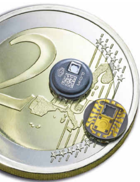
Chip-Packaging im Mikroformat: Bei diesem Luftdrucksensor werden Sensor und Auswertelektronik durch das umgebende Gehäuse ankontaktiert
