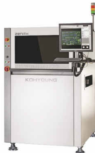
3D AOI-System Zenith sorgt für geringere Pseudofehlerrate sowie Programmier- und Zykluszeiten
