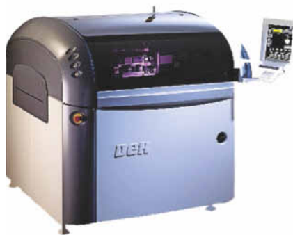
Schablonendrucker DEK Horizon 03iX kann durch die modulare Plattform perfekt den Kundenbedürfnissen angepasst werden
