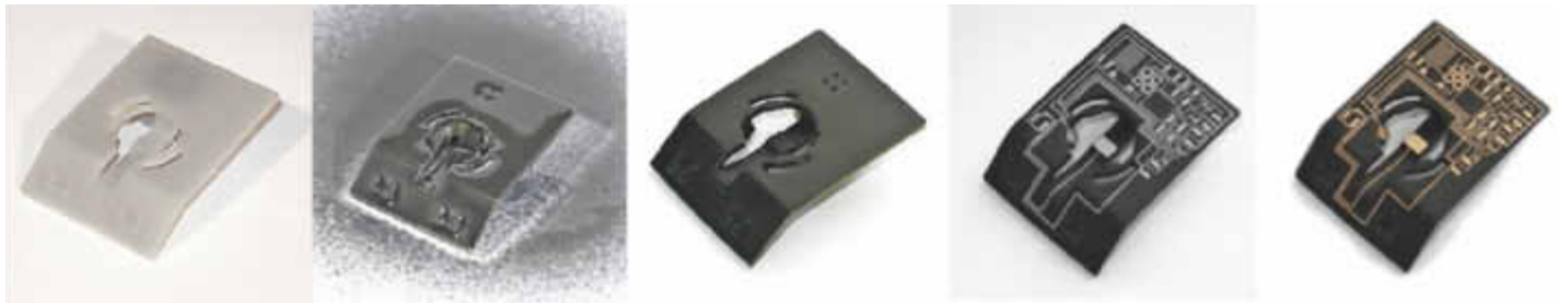
V. l.: Der Grundkörper im 3D-Druck wird mit LPKF ProtoPaint lackiert und getrocknet. Der Laser legt die Strukturen an, in einem stromlosen Bad erfolgt die Metallisierung
