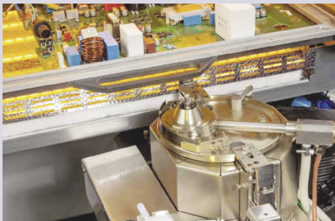
Baugruppe in Vorheizposition mit Unter- und Oberheizung
