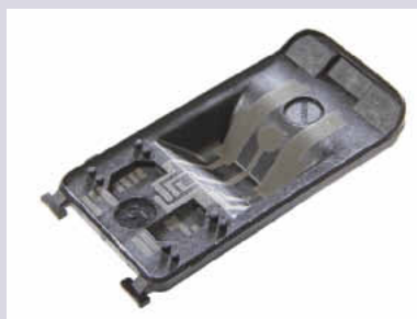
Der Laser aktiviert das Additiv und schafft eine mikrorauhe Oberfläche für eine gute Haftfestigkeit
