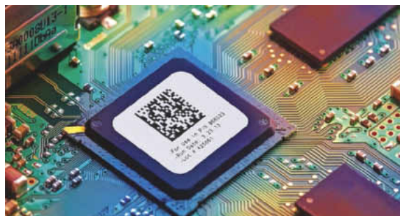
Automatische Kennzeichnung mit speziell entwickelten Polyimid-Materialien
