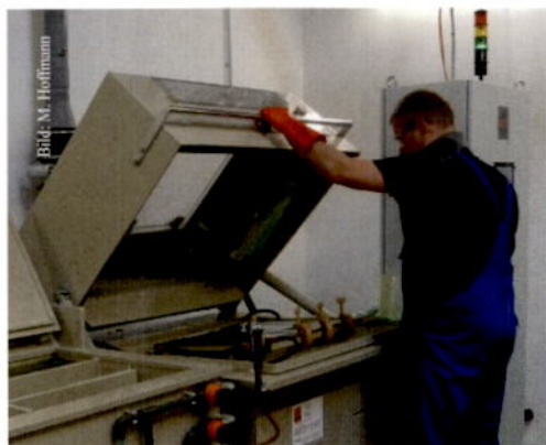
Automatische Anlage zum Elektropolieren von SMD-Schablonen
