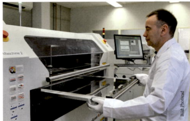
Die nächste SMD-Schablone wird in der LPKF-Laseranlage produziert
